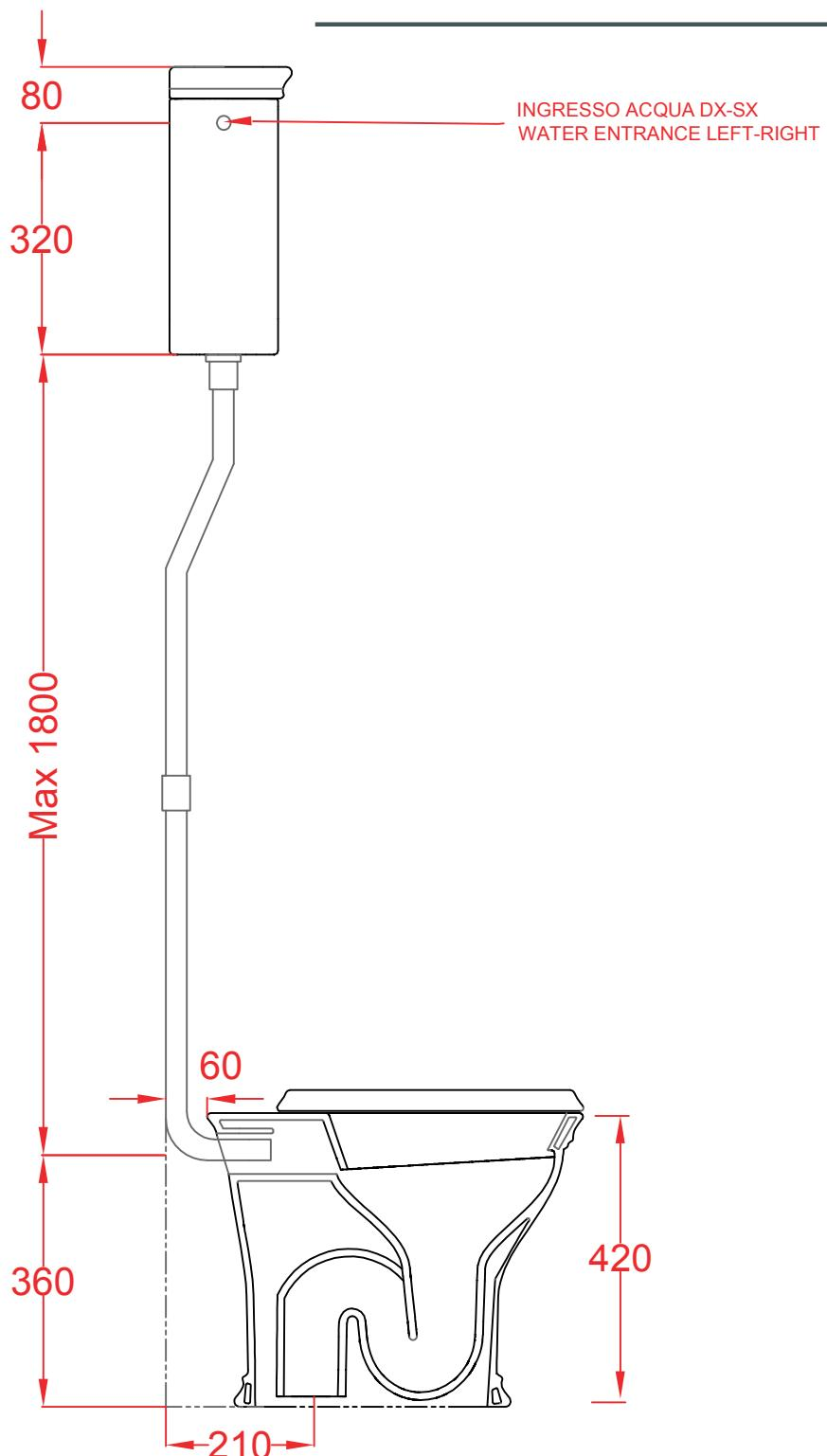
N.B. Le misure indicate possono subire una variazione dell 0,6% circa, dovuta ad usura stampi e a variazioni delle caratteristiche tecniche relative alle materie prime che compongono l'impasto .
