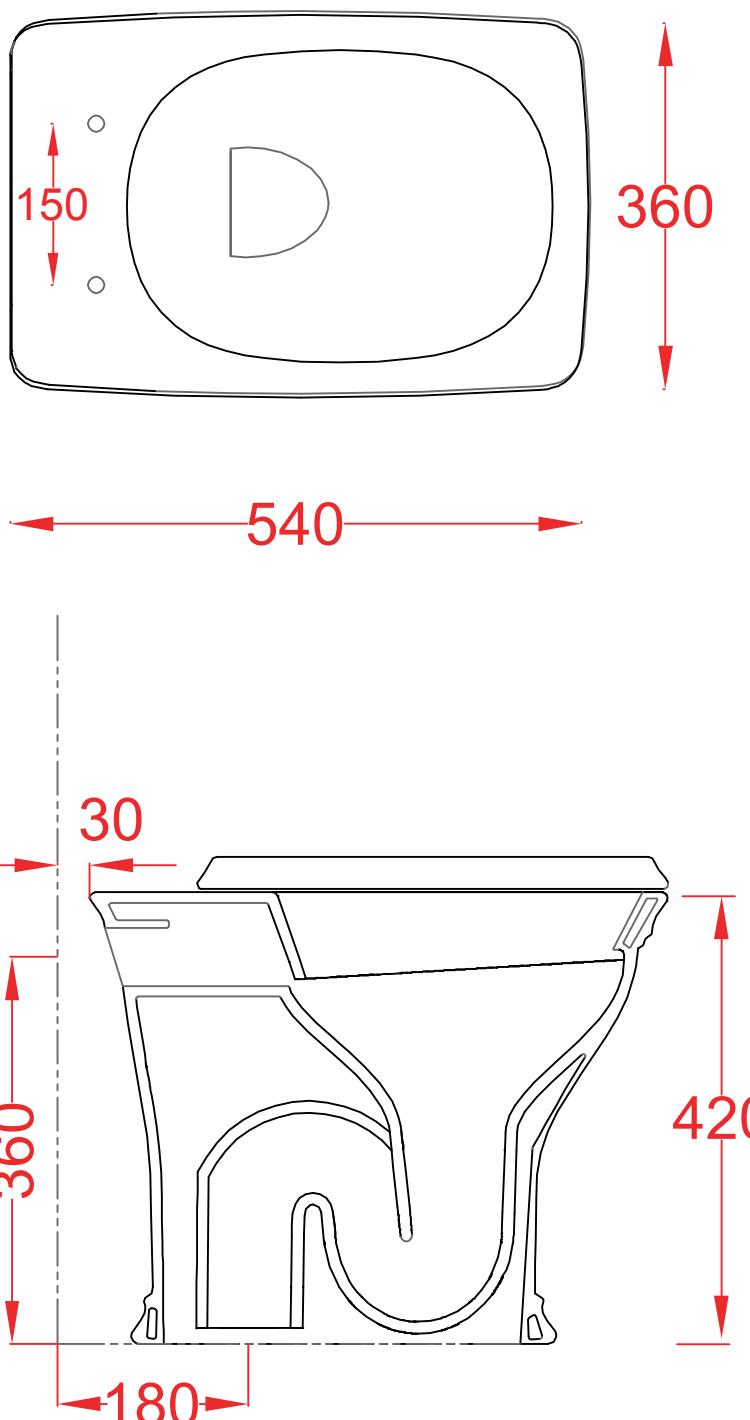
N.B. Le misure indicate possono subire una variazione dell 0,6% circa, dovuta ad usura stampi e a variazioni delle caratteristiche tecniche relative alle materie prime che compongono l'impasto .
